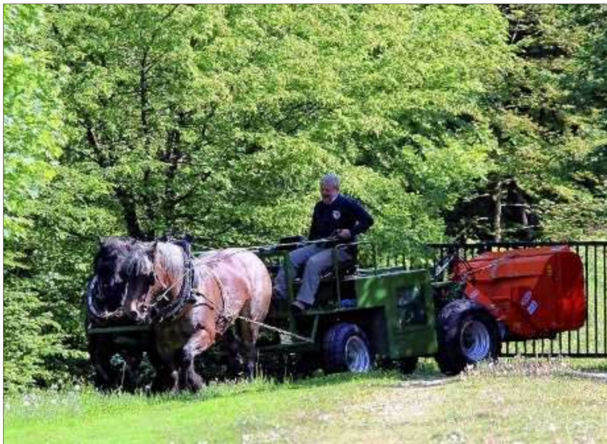
Le porte-outil attelé aux chevaux de trait, construit sur mesure, permet d'accrocher tout type d'accessoire pour réaliser avec un tracteur. Photo Samuel MOREAU
